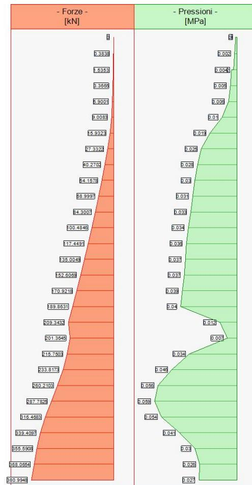
Forze (totali) e Pressioni lungo il fusto, per il Caso 9 ( Q.PERM. [ Quasi\_Perm ] - SLE quasi permanente )
