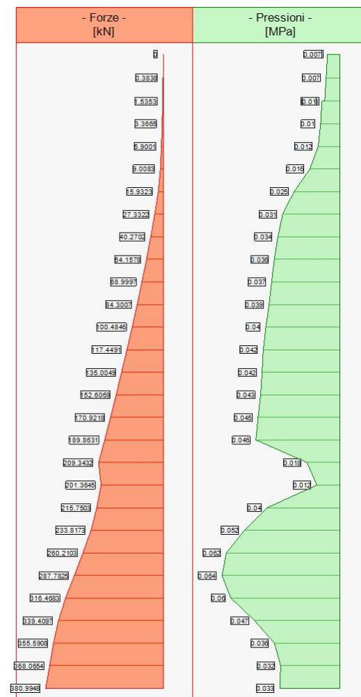
Forze (totali) e Pressioni lungo il fusto, per il Caso 3 ( SLV\_SISMA\_SU [ SLV ] - Sisma\_1+1+R\_Su )
