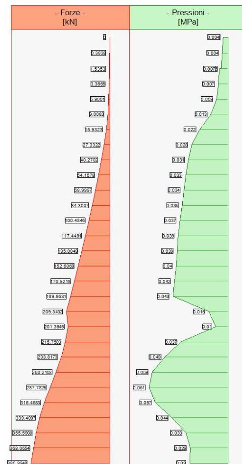
Forze (totali) e Pressioni lungo il fusto, per il Caso 5 ( SLD\_SISMA\_SU [ SLD ] - Sisma\_1+1+R\_Su )
