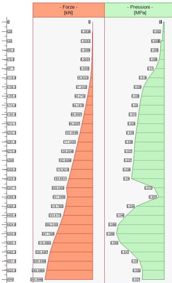
Forze (totali) e Pressioni lungo il fusto, per il Caso 7 ( RARA [ Caratteristica ] - SLE caratteristica (rara) )
