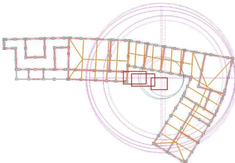
Nella Figura soprastante sono evidenziati con rettangoli rossi le posizioni in cui ricade il baricentro e, osservando i risultati, si deduce che la posizione ottenuta è corretta in quanto la struttura presenta una sezione ad L in pianta. Per tale sezione è noto che il baricentro deve ricadere a circa 1/3 della lunghezza della manica, posto in una posizione interna alla sezione, e mai esterna.
