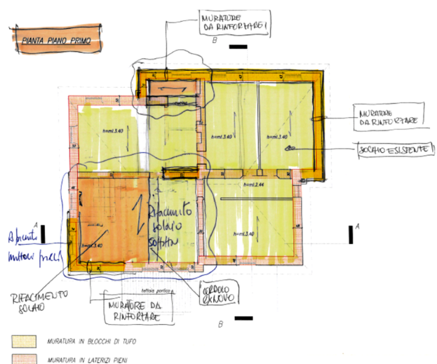
Figura 10 - Schema intervento solaio sottotetto
