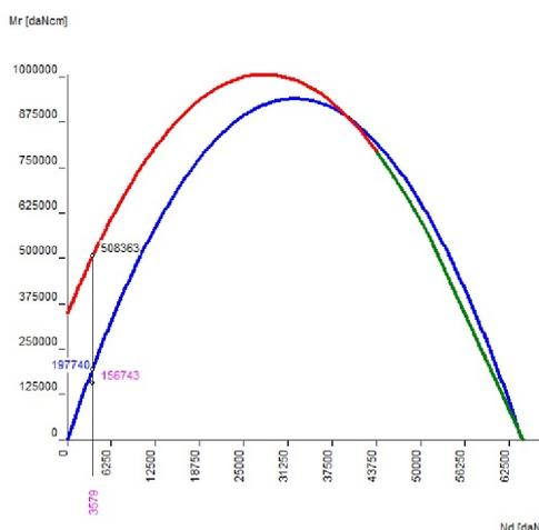
( inserendo un non altrettanto alto valore del  $\gamma_{\text{modello}}$  e una deformazione ultima della rete più realistica, nonché un coeff. di confinamento pari ad uno ) ottenere un comportamento del rinforzo “a muratura con armatura uniformemente distribuita e parzializzabile” : si nota come in questo caso il rinforzo migliora il momento ultimo principalmente nel tratto di scarso sforzo normale
