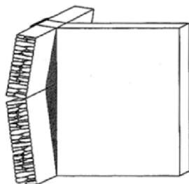
efficaci vincoli di connessione con gli orizzontamenti, e riceve delle spinte orizzontali localizzate : se il collegamento alle pareti ortogonali è carente, si crea una cerniera cilindrica orizzontale che divide la parete in due blocchi: in questo caso l'utente disegnerà il contorno del solido di rottura, ed assegnerà la quota della cerniera cilindrica di separazione dei due blocchi
