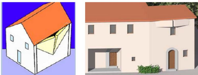
In generale, il meccanismo di flessione orizzontale si manifesta in pareti vincolate a muri ortogonali, solitamente in presenza di coperture spingenti e mal collegate in sommità,, e si traduce nella formazione di cunei di distacco che ruotano rigidamente intorno a cerniere cilindriche.
