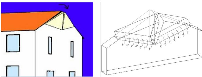
Questo tipo di cinematismo è in genere provocato dall'azione ciclica di martellamento della trave di colmo della copertura. La presenza di travi di colmo di notevoli dimensioni diventa in fase sismica causa di spinte elevate, che possono determinare il distacco di elementi cuneiformi : questi macroelementi
