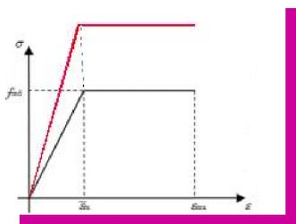
l'altro è il materiale muratura, non resistente a compressione, con resistenze amplificate dal coeff. di confinamento
