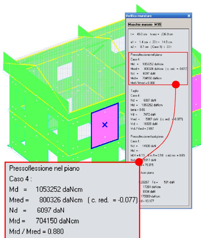
Un ulteriore e più approfondito controllo delle proprietà di resistenza e dello stato di verifica dell'elemento maschio murario si può ottenere tramite il comando “*Murature* → *Domini di resistenza*”, selezionando l'elemento di interesse: queste proprietà vengono riassunte in un pannello contenente i domini di resistenza dell'elemento per le varie verifiche.
