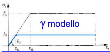
Ipotizziamo quindi che la sezione resistente sia composta da due materiali divisi fra loro dall'asse neutro, dei quali uno è l'armatura uniformemente distribuita, non resistente a compressione, con resistenze penalizzate dal  $\gamma_{modello}$ , e con un eventuale pianerottolo di snervamento
