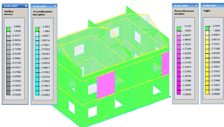
Posso poi analizzare in dettaglio gli elementi che vanno in crisi, e che ho individuato con l'aiuto delle mappe cromatiche, tramite il comando “*Murature* → *Verifica murature* → *lettura locale*”: seleziono quindi l'asta appartenente al maschio murario (o la fascia di piano) per controllare contemporaneamente tutte le verifiche eseguite su quell'elemento.
