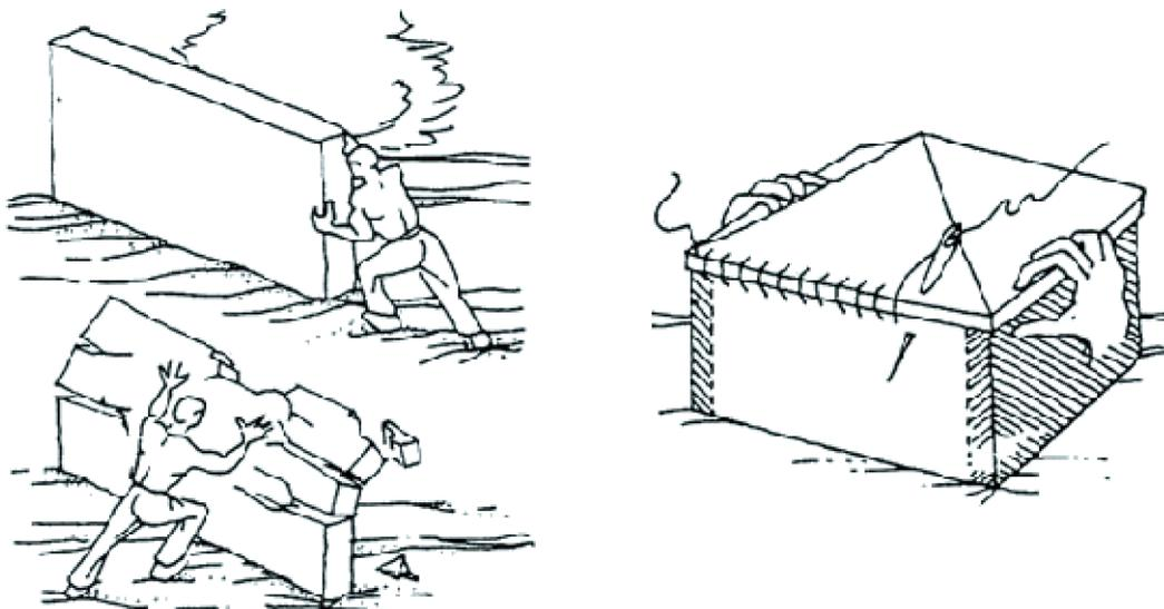
Un edificio in muratura è una struttura complessa in cui tutti gli elementi cooperano nel resistere ai carichi applicati: la complessità del comportamento reale di tali strutture porta spesso a svolgere il progetto e l'analisi strutturale introducendo notevoli semplificazioni. Se la geometria della parete e delle aperture è sufficientemente regolare, è possibile modellare una parete muraria tramite un **telaio equivalente**.
