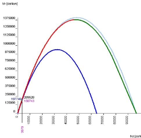
( inserendo un alto valore del  $\gamma_{\text{modello}}$  e della deformazione ultima della rete, e un coeff. di confinamento maggiore di uno ) ottenere un comportamento del rinforzo come puro moltiplicatore delle resistenze : in tal caso il dominio di resistenza costruito come descritto in precedenza ricalcherà quasi quello ( colorato in azzurrino ) di una sezione in muratura avente resistenze moltiplicate del coeff. di confinamento
