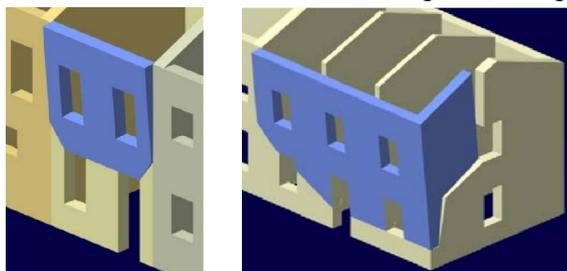
in presenza di lesioni nelle pareti ortogonali, e/o di spinte non contrastate sulla parete, potrebbe attivarsi un meccanismo di ribaltamento, semplice o composto. Il meccanismo consiste di una rotazione rigida di porzioni di parete, o dell'intera parete, attorno ad una cerniera cilindrica orizzontale posta alla base del solido interessato dal cinematicismo.
