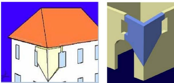
Il meccanismo si manifesta attraverso la rotazione rigida di un cuneo di distacco, delimitato da superfici di frattura ad andamento diagonale nelle pareti concorrenti all'angolo, rispetto ad una cerniera posta alla base del solido.
