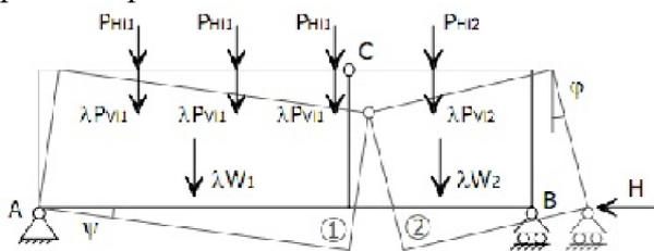
Lo schema statico del PdLV diventa così (visto dall'alto) uno schema cerniera-carrello, ove il carrello è rappresentativo dell'insufficiente confinamento offerto dai muri di controvento. Per poter valutare la forza limite  $H$  rappresentativa della resistenza offerta dalla parete di controvento, il programma chiede quale parete pensare come
